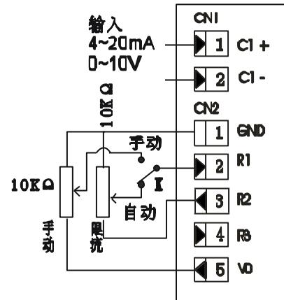
5: 自动+手动+外部电流限制控制
