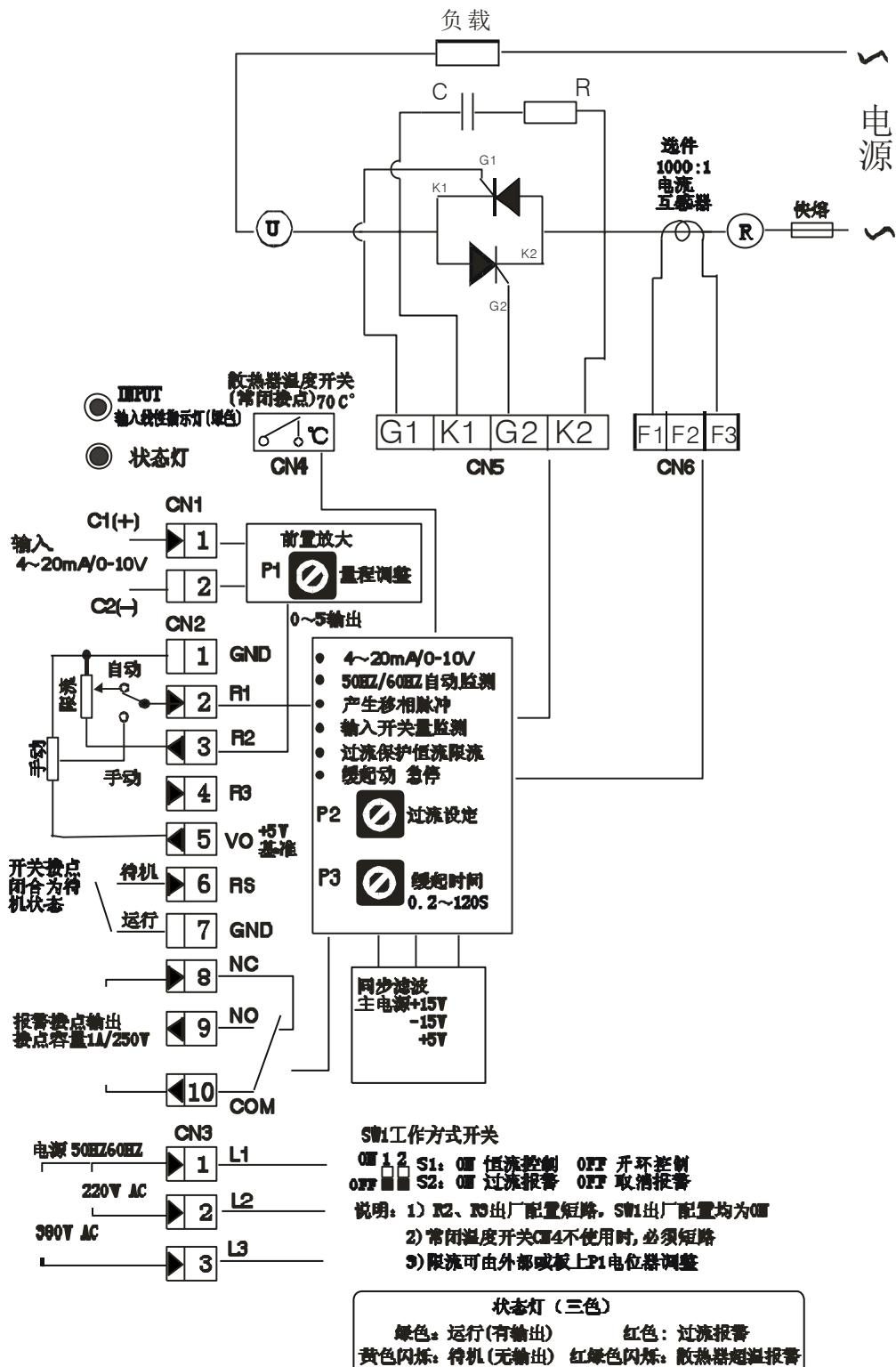
PAC26P-02A电原理框图(限压、恒压控制)
